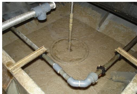
液状化処理後のポテトピール
