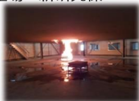
可動式昇降天井による消火実験 (同社資料より)
