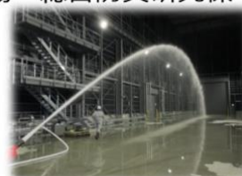
大空間での屋内放水実験
