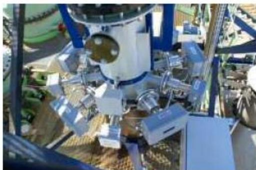
レーザー式ガス濃度計測装置
