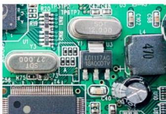
高絶縁性、高強度性、耐熱性、寸法安定性などの特長を持つグラスファイバー(ガラスクロス)は、プリント配線基板材料に最も適した材料であるとされている。
