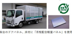
架台のドアパネル、床材に「茶殻配合軽量パネル」を使用
