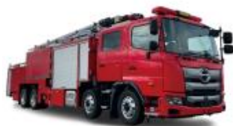
消火薬剤タンク付き大型化学高所放水車 インテグレートワン
