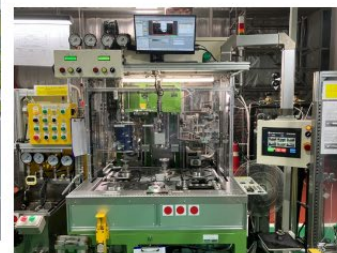
画像処理技術を用いた内製の弁座漏れ検査設備
