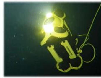
水中ドローンによる構造物目視検査
