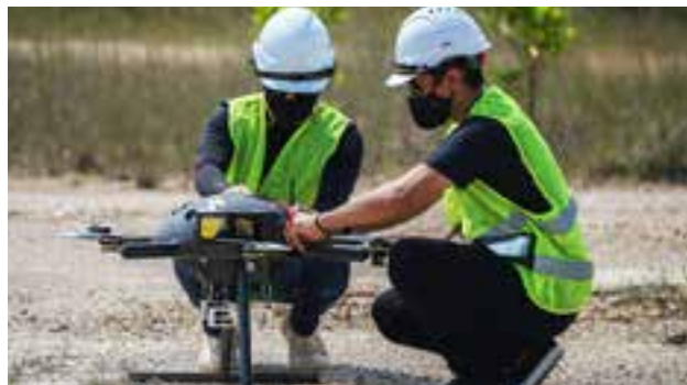
1,000時間の飛行試験実施 エアロダイナミクスと連携し、1,000時間に及ぶマレーシアでの連続飛行を実施。レベル4に向けてドローンのシステム全体の性能・耐久性評価を行った。
