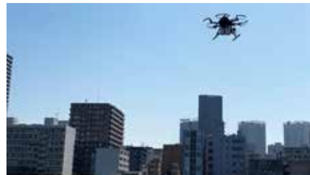
都心を飛ぶドローン (隅田川での実証実験) レベル4を見据えた医薬品配送の実証実験。荷物受け取りのオペレーション、飛行時の安全性などを検証。
