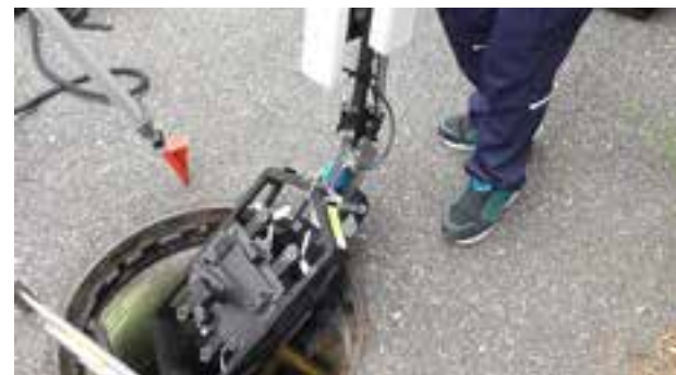
下水管にFI4をおろす 機体開発や生産にとどまらず、下水道点検全体のオペレーションに合わせたソリューション構築。 (NJSとの合併会社FINDi)
