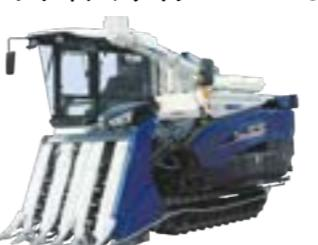
排ガス規制に対応したエンジンの搭載や作業中のエンジン負荷、車速、揺動棚の層厚に応じて作業回転範囲内(グリーンゾーン)でエンジン回転を自動的にコントロールするIQ脱穀制御を搭載したフロンティアファイターHFR475、5075(4・5条)を「エコ商品」に認定しました。
