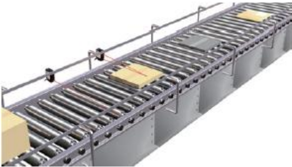
段ボールの通過確認
