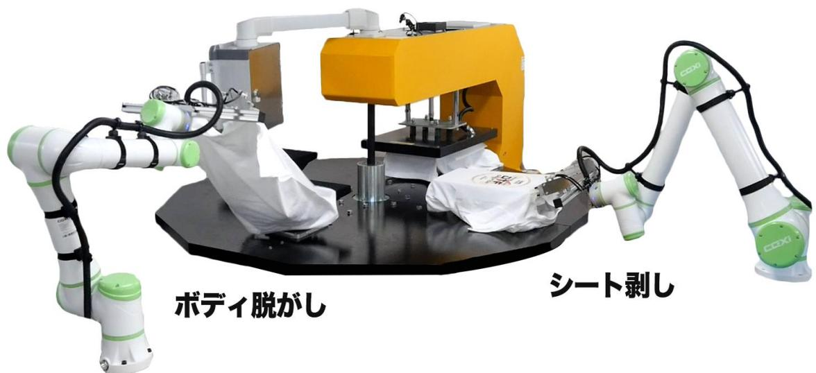
回転プレス機と協働ロボット2台（シート剥がし、ボディ脱がし）
